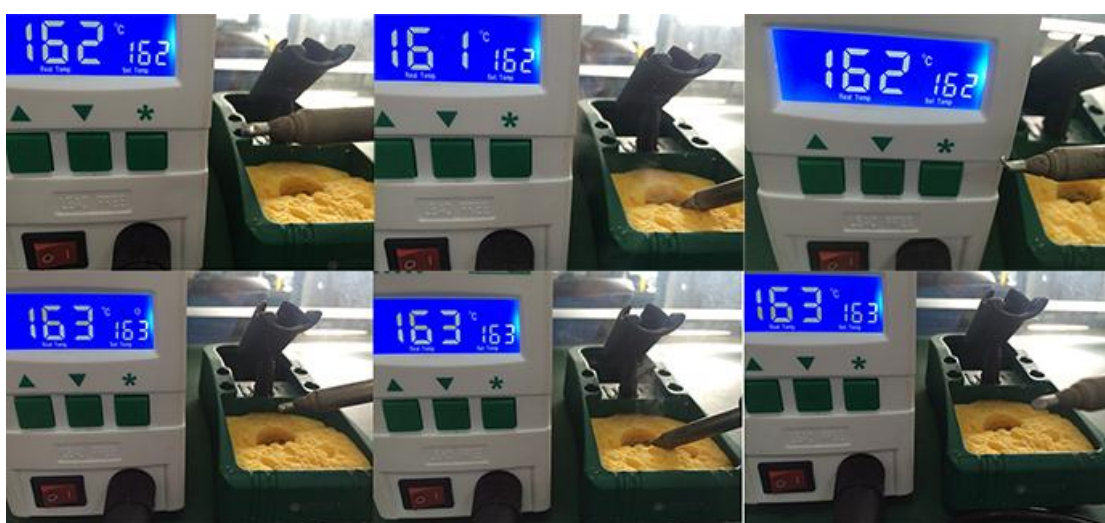
图 5. 正品焊锡共晶温度正负 1° 擦拭实验
