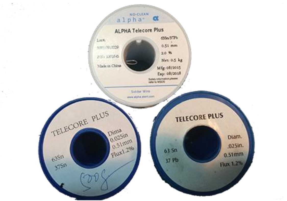
图 1. 待测 alpha 63/37 焊锡
