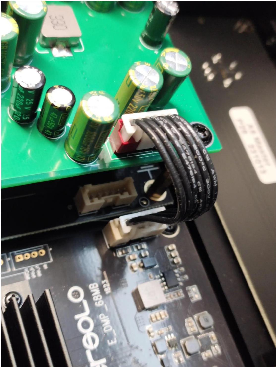
用原机排线连接线性电源板和主机板
